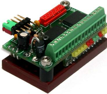
Der Baustein wird fertig aufgebaut und getestet geliefert. Die vier Servokabel müssen in den Empfänger Kanal 1, 2, 3, und 4 gesteckt werden. Befestigen Sie den Baustein mit zwei 3mm Schrauben. Die passenden Gewindelöcher befinden sich auf der Unterseite der Aluplatte. Achtung, nicht zu lange Schrauben verwenden, sonst könnte die darüberliegende Platine beschädigt werden!
